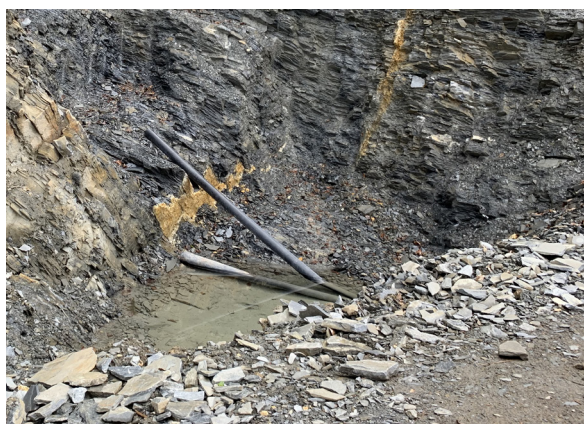
Probebohrungen auf der Alp il Bot: Kann die Quelle noch besser gefasst werden, so dass der Wasserbedarf auf dem Bot gesichert werden kann?
